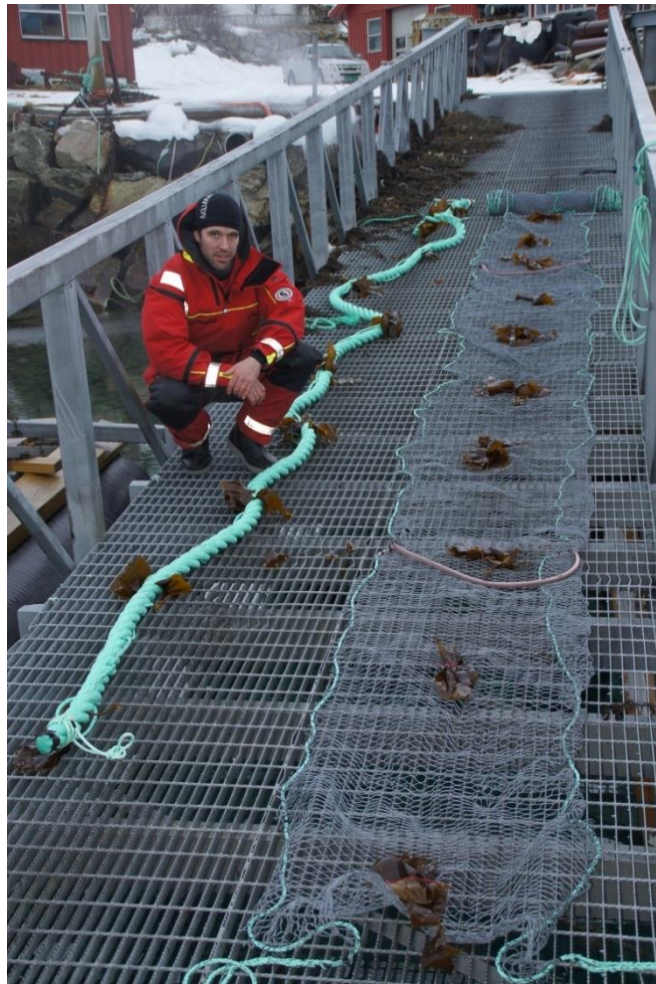
Figur 2 Det fortyngede tauet (tau) og notlinspanel (panel) testet i de eksperimentelle forsøkene.
